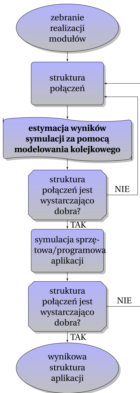
Rysunek 2.3: Schemat procesu projektowania z zaznaczonym nowym etapem
