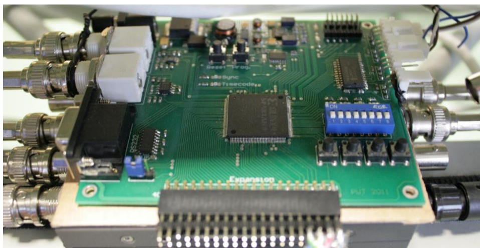
Rysunek 2.3.3 – Zdjęcie prototypu konwertera sygnałów synchronizacyjnych.
