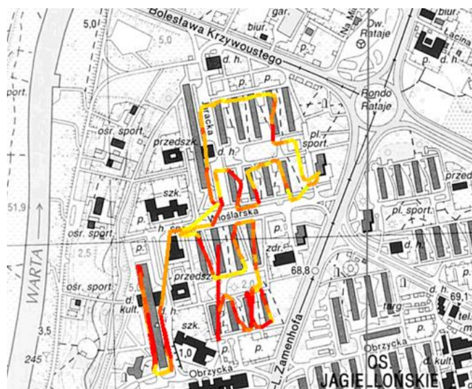
Rys. 1. Przykładowe zobrazowanie wyników pomiaru wycieków na mapie kartograficznej (skala kolorów została usunięta)
