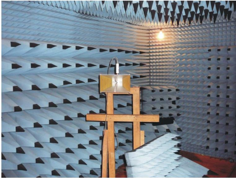
Rys. 7.13. Zdjęcie stanowiska pomiaru anten w komorze bezodbiciowej.
