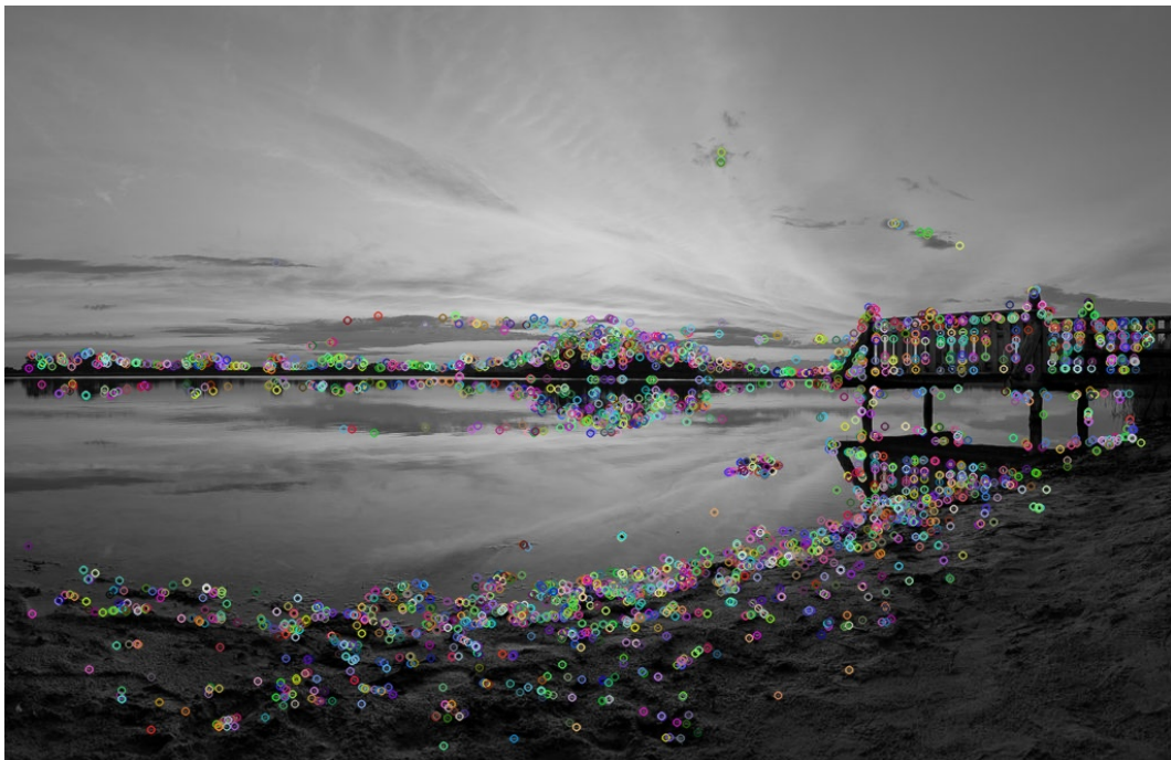
RYSUNEK 3.5: Zaznaczenie punktów charakterystycznych przez algorytm BRISK
