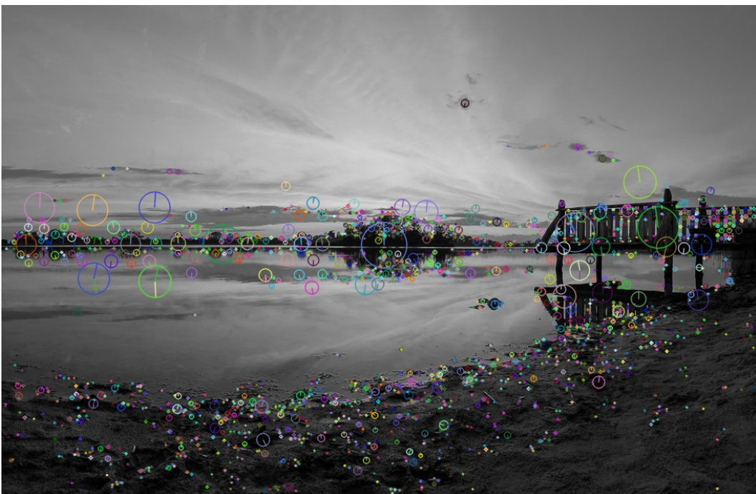
RYSUNEK 3.2: Zaznaczenie punktów charakterystycznych przez algorytm SIFT z uwzględnieniem wektora kierunkowego oraz rozmiarem deskryptora
