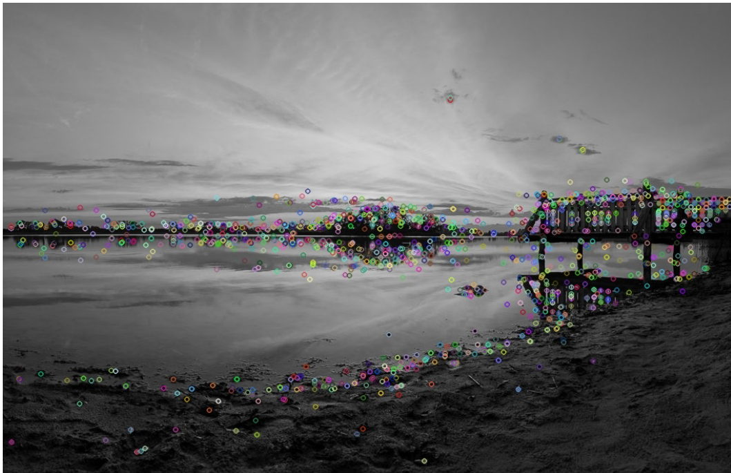
RYSUNEK 3.3: Zaznaczenie punktów charakterystycznych przez algorytm KAZE
