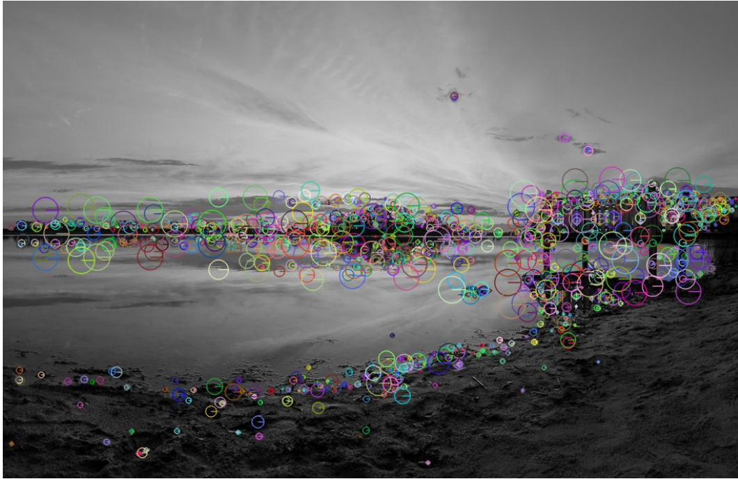
RYSUNEK 3.4: Zaznaczenie punktów charakterystycznych przez algorytm KAZE z uwzględnieniem wektora kierunkowego oraz rozmiarem deskryptora
