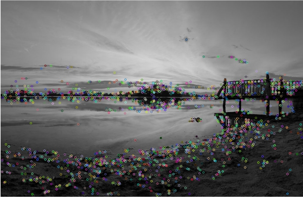
RYSUNEK 3.1: Zaznaczenie punktów charakterystycznych przez algorytm SIFT
