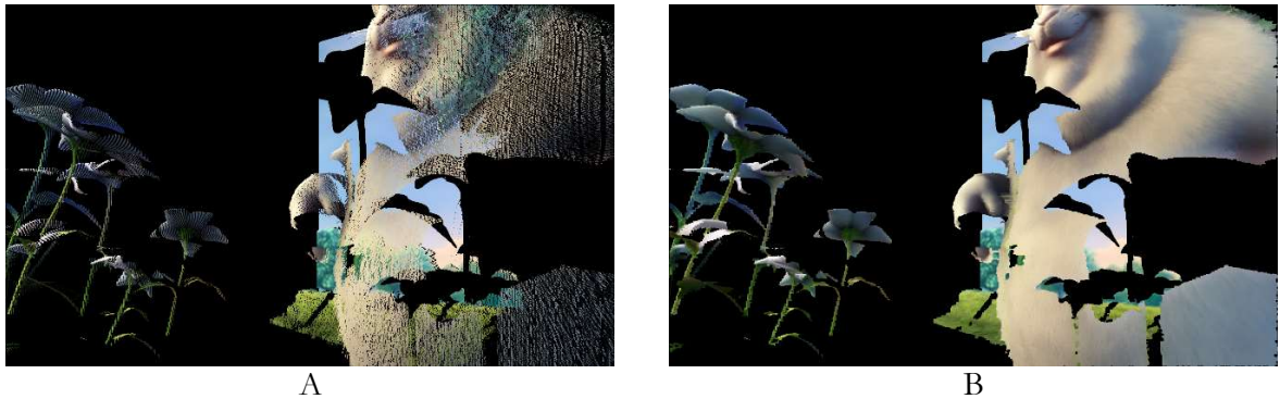
Rysunek 3.7. Porównanie niezależnego rzutowania punktów (A) i rzutowania zapewniającego ciągłość obiektów (B); sekwencja BBB Flowers (B, D), synteza z widoku 06 do 84
