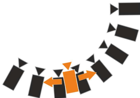
Rysunek 1.1. Ilustracja idei swobodnej nawigacji; kolorem czarnym oznaczono rzeczywiste kamery, pomarańczowym – kamerę wirtualną, z której użytkownik systemu ogląda obraz i której pozycję może on w dowolny sposób zmieniać
