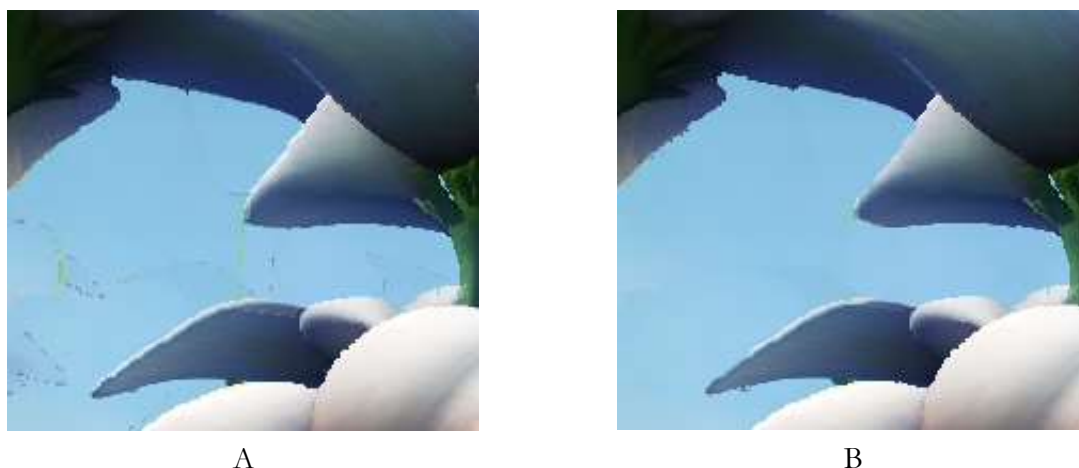
Rysunek 3.4. Fragment widoku wirtualnego zsyntezowanego bez zastosowania filtracji (A) i z filtracją (B)
