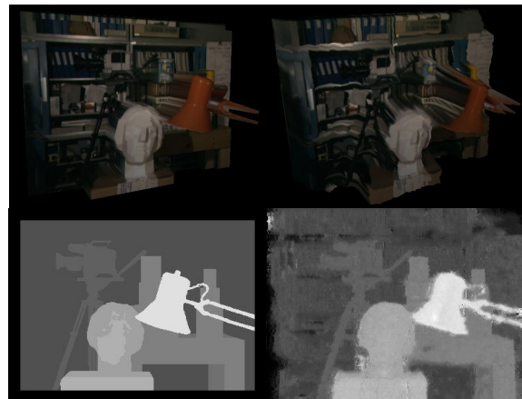
Rys. 6. Porównanie otrzymanej mapy rozbieżności (po prawej) z Ground Truth (po lewej) dla obrazu Tsukuba
