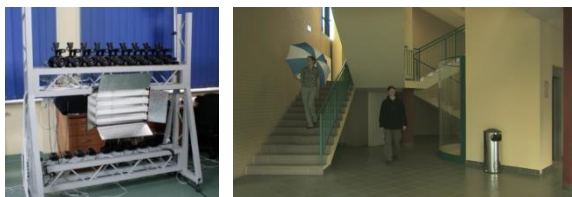
Rys. 3. Eksperymentalny system wielokamerowy (po lewej) powstały w Katedrze Telekomunikacji Multimedialnej i Mikroelektroniki z aktywnym udziałem autora rozprawy, wykorzystany min. do przygotowania sekwencji testowej „Poznan Hall” (po prawej)
