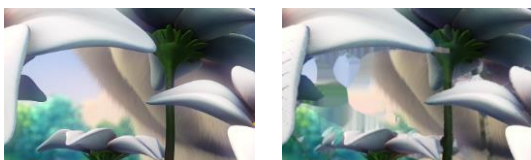
Rys. 3. Porównanie fragmentu oryginalnego widoku z sekwencji BBB Flowers z obrazem zsyntezowanym (przy użyciu VSRS) z wypełnionymi odsłonięciami
