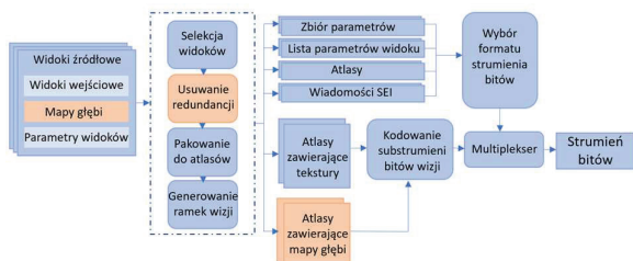
Rys. 2. Schemat kodera profilu MIV Main. Na pomarańczowo zaznaczono te elementy, których nie wykorzystuje koder profilu MIV DSDE.
